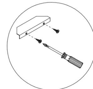
Согласно схемы приложите ручку и закрепите саморезами, входящими в комплектацию ручки.
