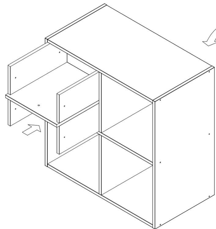
Выставьте вровень с задней кромкой горизонтальных стенок стеллажа и зафиксируйте шурупами
